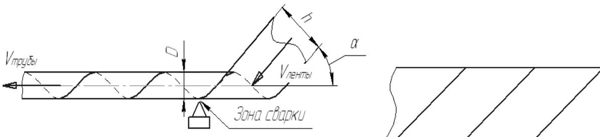
Диаметр трубы 0,2 м, ширина полосы 0,2 м, толщина металла 0,001 м, скорость выхода готовой трубы 0,1 м/с, теплоемкость стали 460 Дж/(кг·К), плотность стали 7900 кг/м<sup>3</sup>, теплота плавления стали 84 кДж/кг.
