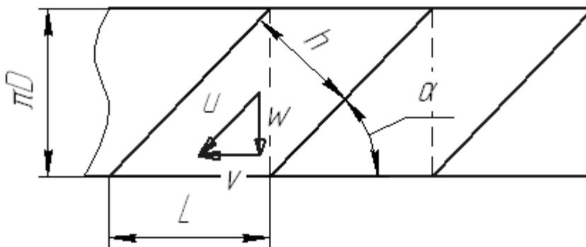
Ширина продольного раскроя равна длине окружности с диаметром трубы. В этом случае угол намотки связан с шириной ленты и диаметром наматываемой трубы. Вектор скорости подачи направлен под тем же углом, под которым подается лента. Эта скорость связана с линейной скоростью подачи трубы. Частота вращения определяется скоростью поперечного движения ленты  $w$  и диаметром трубы.
