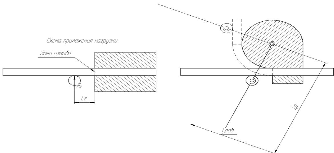
Для изгиба трубы необходимо приложить к ней изгибающий момент, равный произведению усилия инструмента (ролика)  $F_r$  на плечо приложения силы  $L_r$ . Так как в качестве инструмента используется ролик, касательное усилие отсутствует. Гиб профильной трубы (20 x 20 мм) начинается по достижении момента 240 Н·м, до этого момента труба, подобно пружине, изгибается упруго (возвращается в исходное состояние после снятия нагрузки). Коэффициент изгибной упругости трубы составляет 70 Н·м/°.
